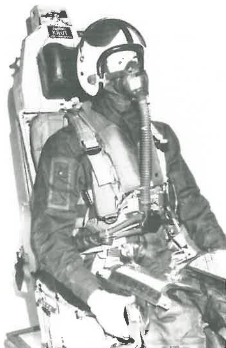
Räddningssystemet omfattar allt från hjälm, syrgasmask och stridsdräkt till nödutrustningspacke med proviant och livbåt
